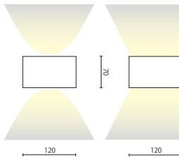
Armonia tra design e luce, Lynn è un apparecchio da parete biemissione realizzato in alluminio verniciato a polvere epossipoliestere stabilizzata ai raggi UV. Fornito con lenti concentriche, viene equipaggiato con sorgenti LED ad alta efficienza e driver. Il grado di protezione contro la penetrazione di polvere, corpi solidi e liquidi è IP44.
